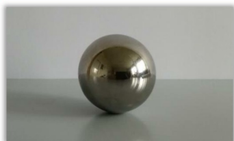
KALIBRIERUNGSKUGEL DURCHMESSER 30 MM
