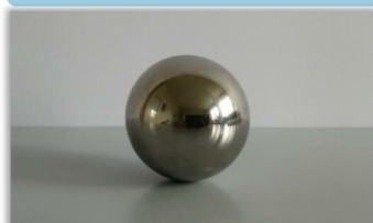
KALIBRIERUNGSKUGEL DURCHMESSER 25 MM
