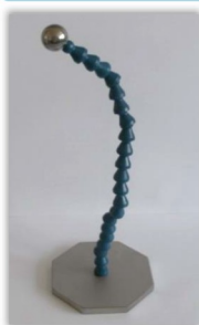
AM SCHWANENHALS AUF UNTERLAGE DURCHMESSER KALIBRIERKUGEL: 25 MM
