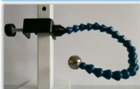
AM SCHWANENHALS AN MOBILER HALTERUNG DURCHMESSER KALIBRIERKUGEL 30 MM
