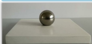
AUF KUNSTSTOFFUNTERLAGE DURCHMESSER KALIBRIERKUGEL 30 MM
