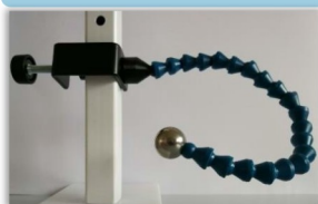
AM SCHWANENHALS AN MOBILER HALTERUNG DURCHMESSER KALIBRIERKUGEL 25 MM
