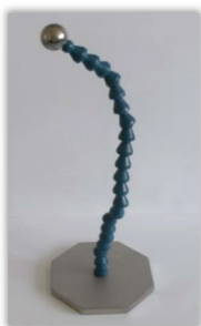
AM SCHWANENHALS AUF UNTERLAGE DURCHMESSER KALIBRIERKUGEL: 30 MM
