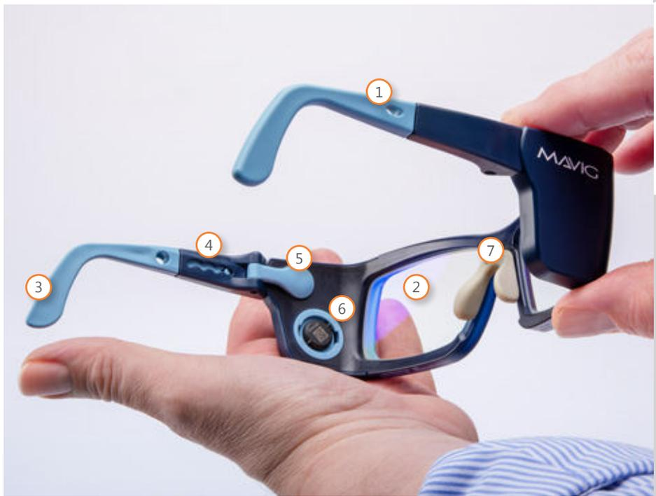
Bei der Überwachung der Augenlinsendosis ist eine konstante Position des bzw. der Dosimeter/s optimal. Zusammen mit den Projektpartner AWST Auswertungsstelle des Helmholtz-Zentrums (Hinweis: mit 1. April 2020 Betriebsübergang auf die Mirion Technologies GmbH) und Dosilab hat MAVIG eine neue Art von Röntgenschutzbrille entwickelt, welche die Augenlinsendosimetrie integriert.
