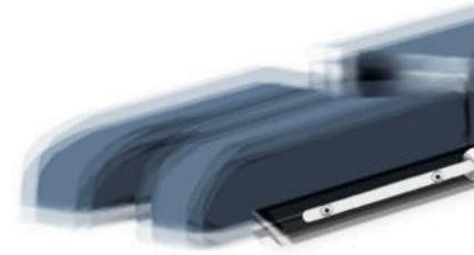
Universell einsetzbares Set, bestehend aus 3 Untertisch-Lamellen zum Einhängen in Tischprofilschienen 25 x 10 mm oder 25 x 9 mm (HxB), Schutzklasse III (Pb 0,5 mm) gemäß DIN 6857-1:2009-1, Röntgenröhren-Spannungsbereich 50 - 120 kV
