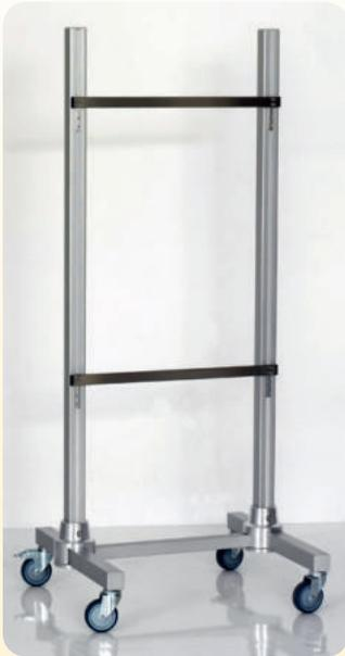
**Abb. links:** Gerätewagen mit 2 Normschielen 25 x 10 mm, 2 Profilstangen mit Nut vorne und hinten zur Befestigung von Normschielen, Fußgestell aus Alu, H/T/B 175 x 50 x 60 cm, Normschielen und Ausleger verstellbar, zur Aufnahme von Gastroboxen und TEE-Sondenboxen mit Höhe 180 cm, Gewicht: 12,5 Kilogramm.
